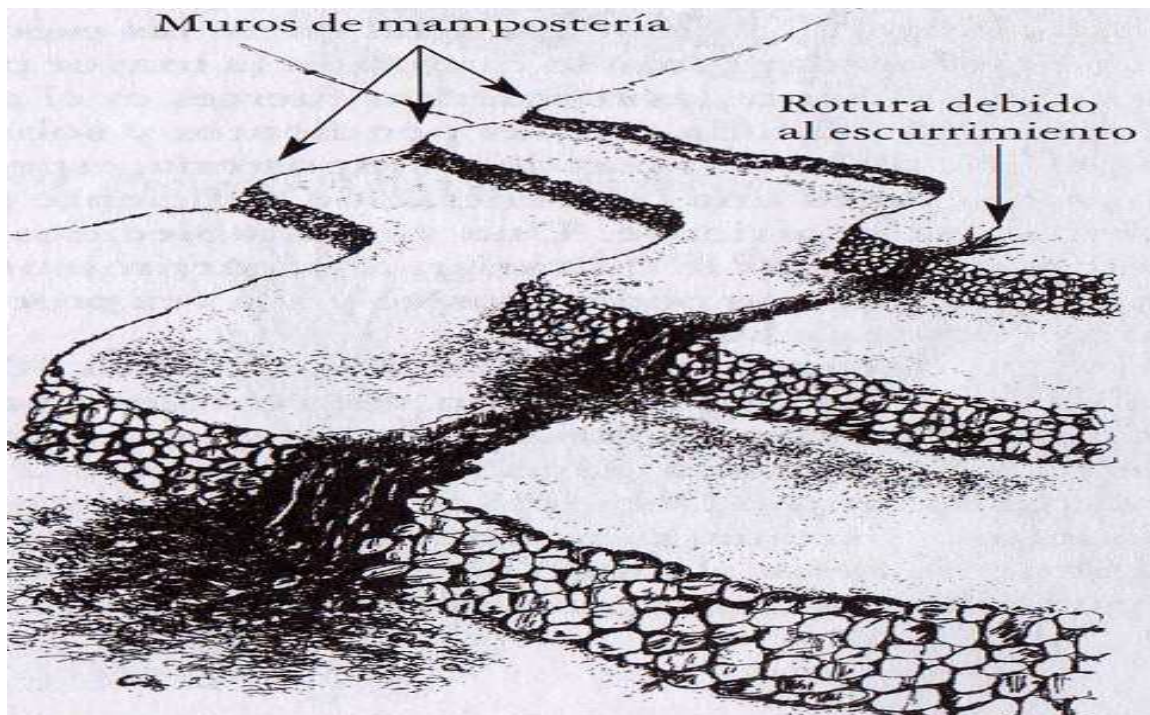
Figura 40. Terrazas de mampostería
