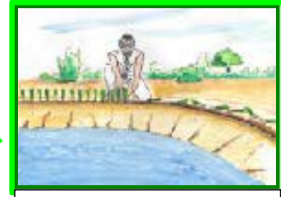
Illustration d'une installation de vétiver sur la berge d'un bassin de rétention
