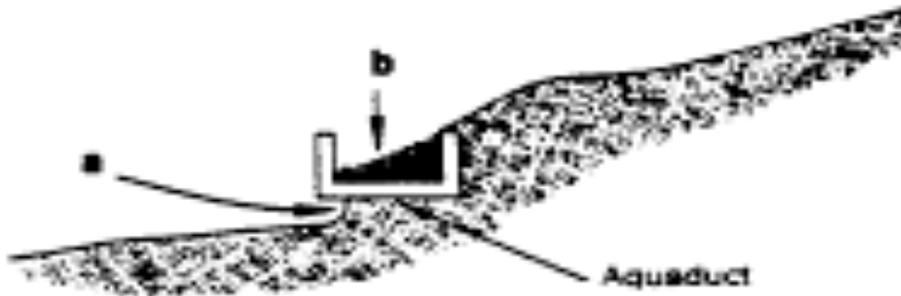
(b). Pour remédier à cette situation, il est recommandé de planter du Vétiver parallèlement aux côtés supérieur et inférieur du conduit bétonné.
