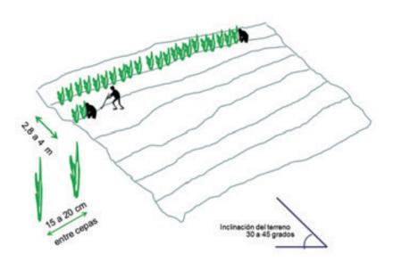
La barrera contra la erosión frena la velocidad y la fuerza destructiva del agua. El sedimento que el agua de lluvia arrastra, queda atrapado detrás de las barreras de Vetiver, paulatinamente formando terrazas inducidas.
