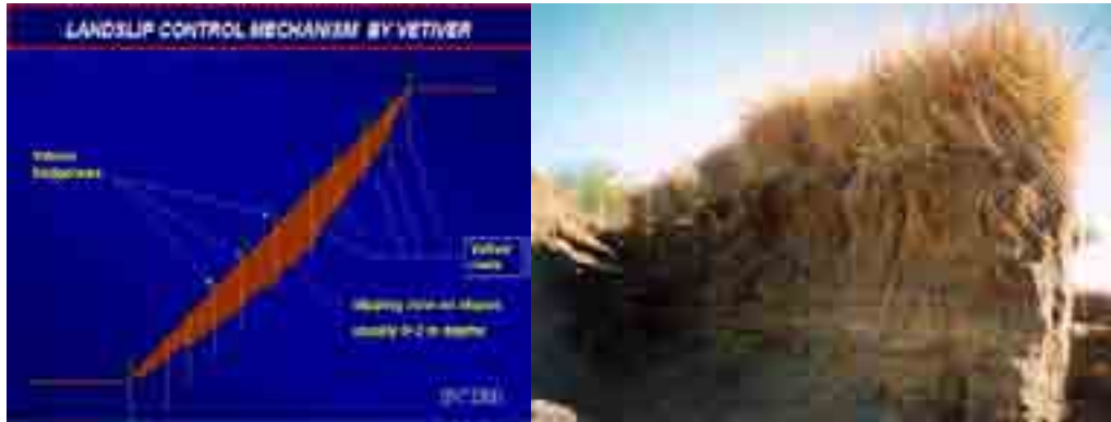
Hình 1: Minh họa nguyên lý ổn định mái dốc bằng cỏ Vetiver (bộ rễ các hàng cỏ có tác dụng như những neo đất (trái). Trong thực tế các hàng cỏ Vetiver đã giúp bức tường đất này khỏi bị nước lũ quét đi (phải)
