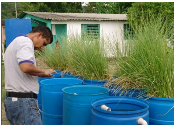
Foto 5. Experimento para tratamiento de aguas contaminadas con fluor. Tesis de maestría. Yazmin Ruiz.
